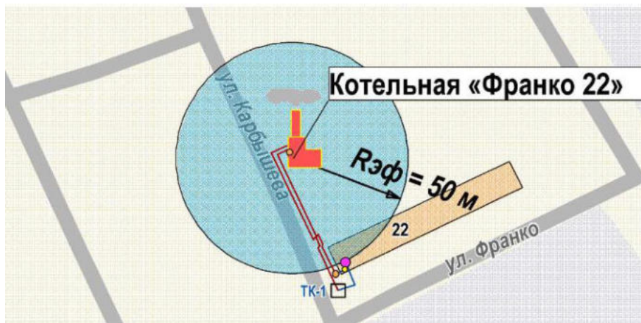
Рис. 3.5. Схема радиуса эффективного теплоснабжения от котельной «Франко 22».
