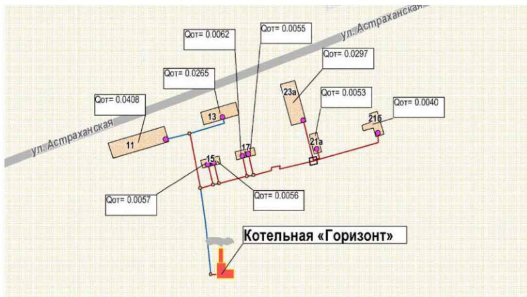
Рис. 2.9. Схема с указанием объемов потребления тепловой энергии от котельной «Горизонт».
