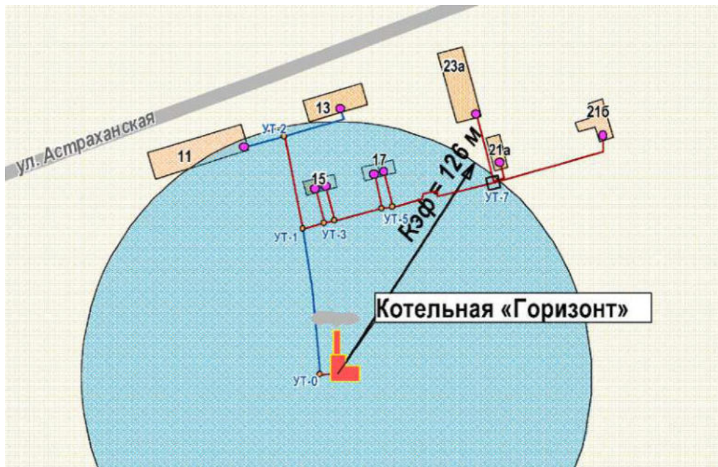
Рис. 3.9. Схема радиуса эффективного теплоснабжения от котельной «Горизонт».
