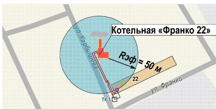
Рисунок 7.5 – Схема радиусов эффективного теплоснабжения от котельной «Франко 22».
