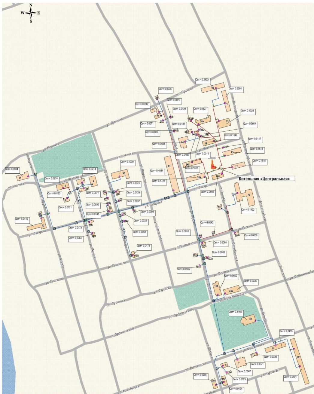
Рис. 1.4 Схема с указанием объемов потребления тепловой энергии от котельной "Центральная"
